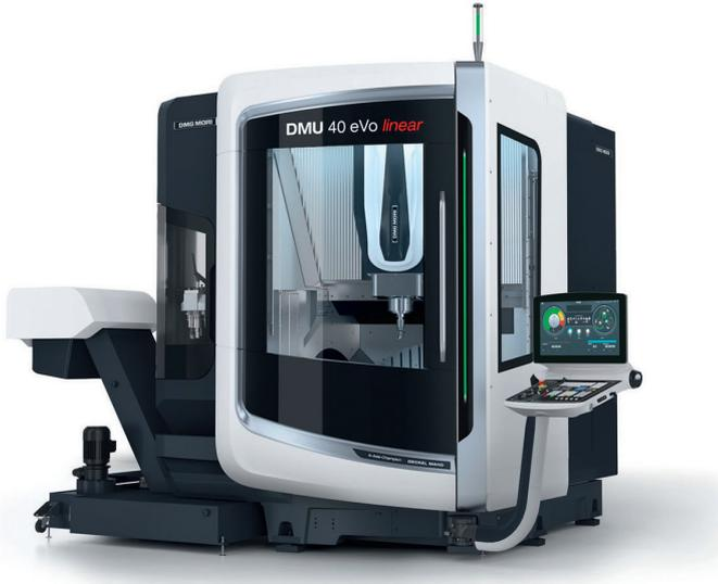
3 Das Bearbeitungszentrum 'DMU 40 eVo linear' von DMG Mori bearbeitet auch schwer zerspanbare Medizintechnik-Werkstoffe effizient, zum Beispiel Titan oder Kobaltchrom. Indem man kompakte Automationsanlagen anbindet, wird eine maximale Produktivität gewährleistet © DMG Mori
