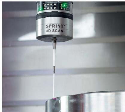
5 Der scannende Messtaster 'Sprint' ermöglicht mit maximal 1000 Messpunkten in der Sekunde eine besonders exakte und schnelle Form- und Lageerfassung der Werkstücke © Renishaw
